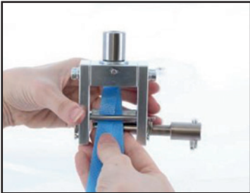
Die Probe einmal zusammenlegen und einfädeln
